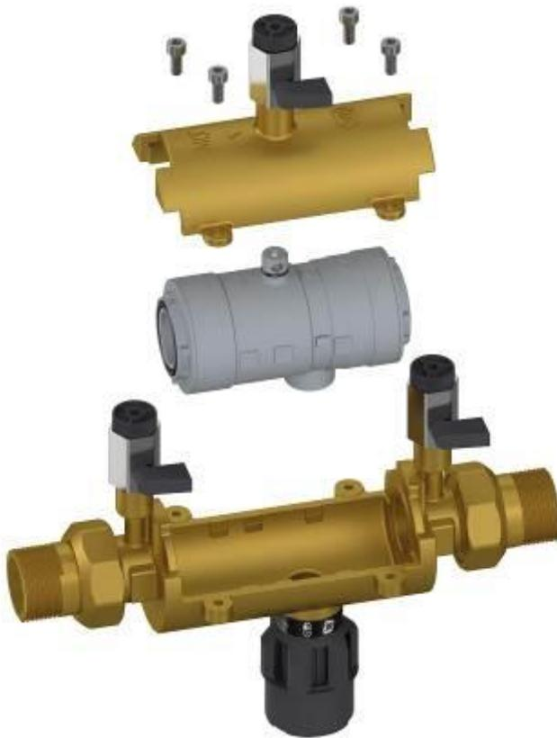
Die innovative Patronentechnik des neuen Systemtrenners BA 6610 inline LF von SYR macht die jährliche Wartung zum Kinderspiel: einfach die Schrauben lösen, den Gehäusedeckel abnehmen, die alte Komplettrone entnehmen, die neue, normkonform geprüfte Komplettrone einsetzen und den Deckel wieder schließen.
